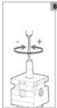
Reglage de la lubrification. Lors de la première utilisation du Lubrificateur, ouvrir la vis au maximum (réf. 32), attendre que l'huile atteigne l'intérieur de la coupole et procéder ensuite au réglage.
