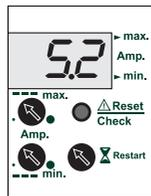
**Moteur stoppé pour avoir dépassé l'intensité maximale (surcharge).**
