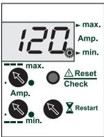
L'équipement peut réarmer automatiquement le moteur suite à un arrêt pour sous-charge.
