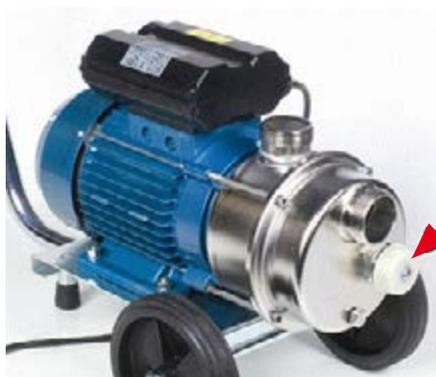
Le by-pass est interne à la pompe. Un orifice à l'intérieur du corps de pompe relie l'aspiration au refoulement. On peut fermer ou ouvrir progressivement l'orifice en tournant la molette située à l'extérieur de la pompe.
