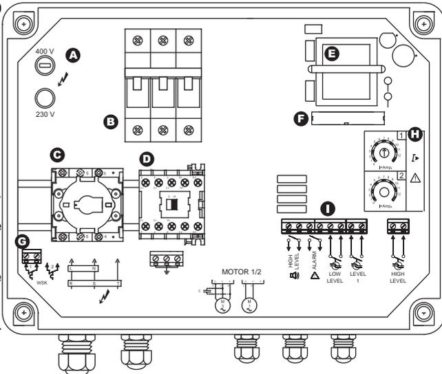
Vérifier que tous les raccordements soient correctement effectués et que le fusible de choix de tension soit bien positionné (230 ou 400 Vac).
